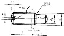
$u$  (不完整螺纹的长度)、 $2P$ ;  $P$ ——螺距。
