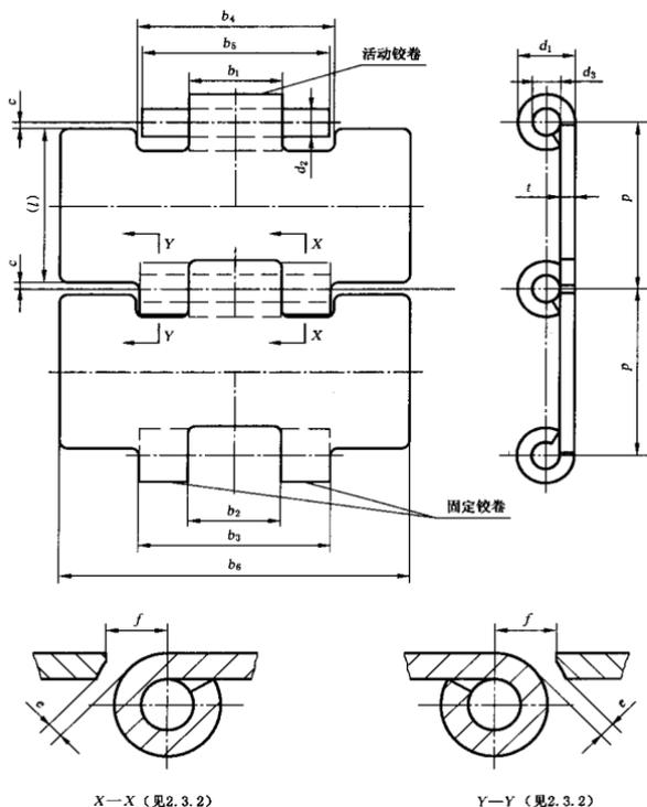
图 1 单铰链式平顶链
